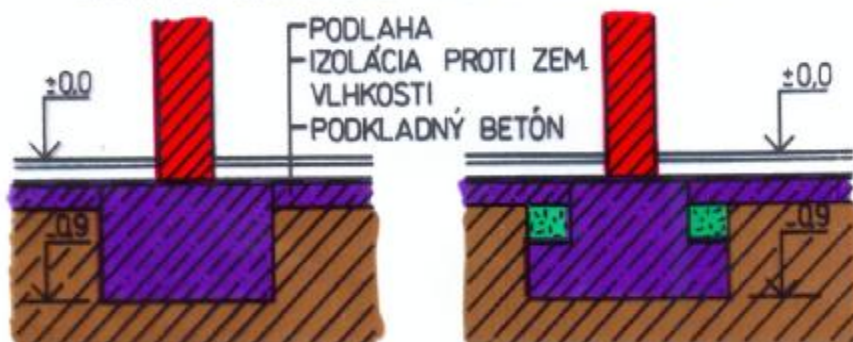
OBR.Č.1 ZÁKLADOVÉ PÁSY Z PROSTÉHO BETÓNU
